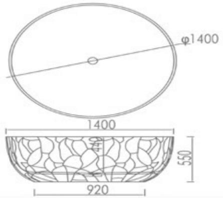
**MATERIAL SEIKO HYDROALUMINITE HIGH-PERFORMANCE COMPOSITE MINERAL**
