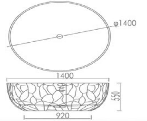
**MATERIAL SEIKO HYDROALUMINITE HIGH-PERFORMANCE COMPOSITE MINERAL**
