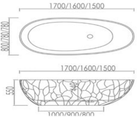
**MATERIAL** SEIKO HYDROALUMINITE HIGH-PERFORMANCE COMPOSITE MINERAL
